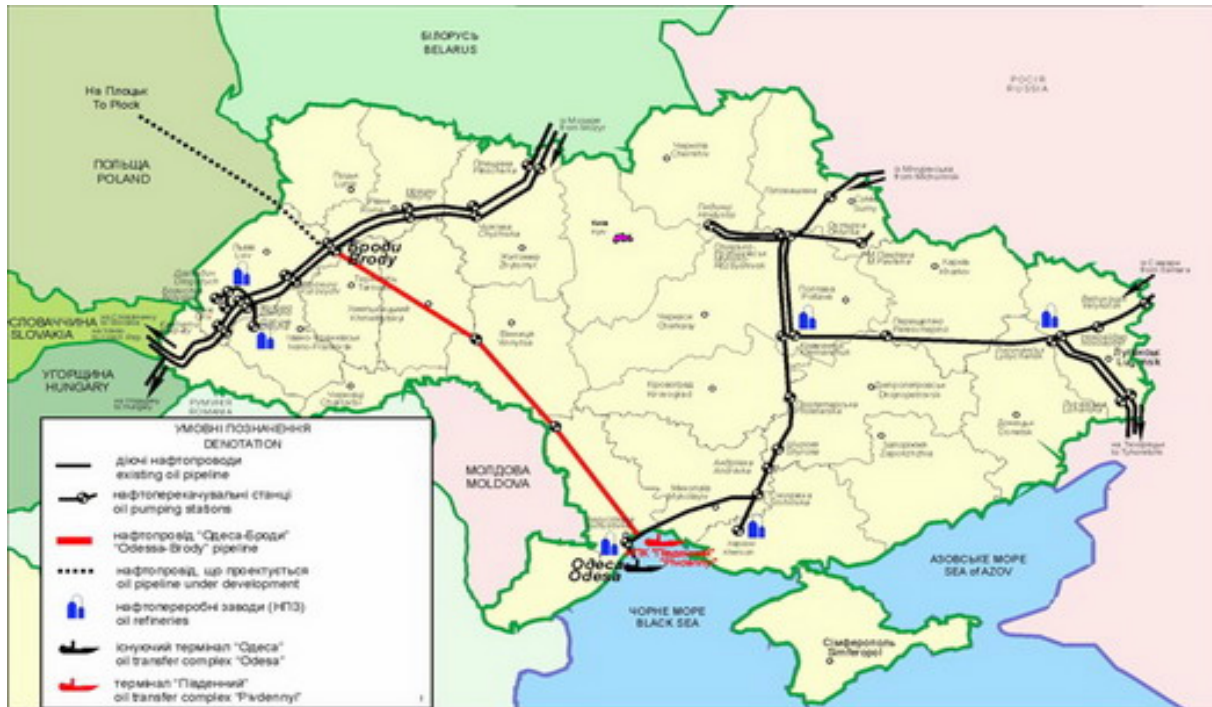
Figura nr. 4 Sistemul de transport al petrolului
